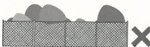
Áttört kerítések nádszövettel való zárása nem megfelelő.
